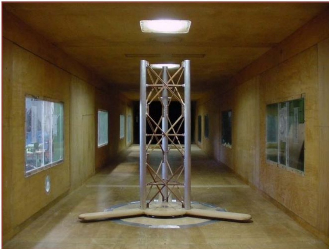
Fotografias do modelo seccional reduzido da torre de secção triangular Seccional Brasil no interior do túnel de vento.
