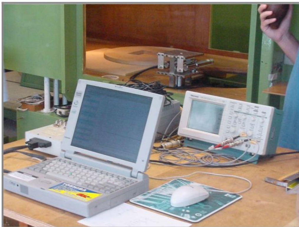
Sistema de condicionamento, monitoramento, e registro de sinais.
