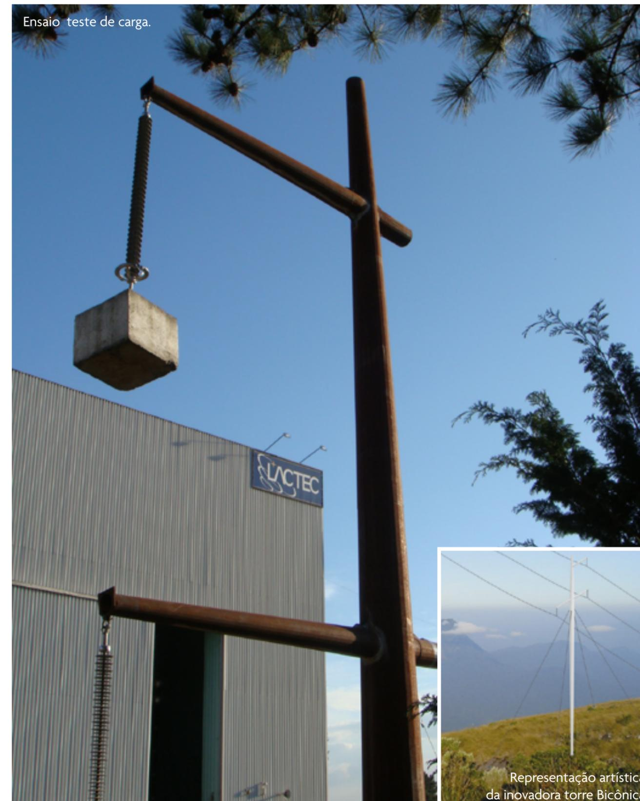
Ensaio teste de carga.
