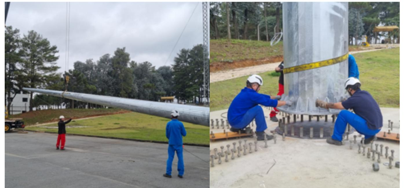
Bancada de testes no Centro Tecnológico 4225 com área disponível de 1200m<sup>2</sup> passível de ampliação, apta a ensaiar estruturas de até 60m de altos carregamentos estruturais.
